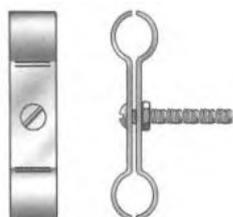
On peut utiliser ces dispositifs de serrage à deux pièces en acier inoxydable comme pièce d'espacement dans des fours ou réservoirs. Idéal pour figures 1, 5, 13, 14, 17 et 18.
