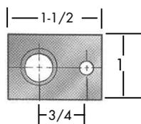
Des brides de montage standard peuvent être ajoutées sur les éléments en usine pour faciliter l'installation. Des brides spéciales sont disponibles sur demande.
